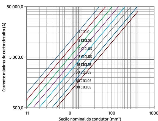
Temperatura em regime permanente de 120°C, conexões prensadas
