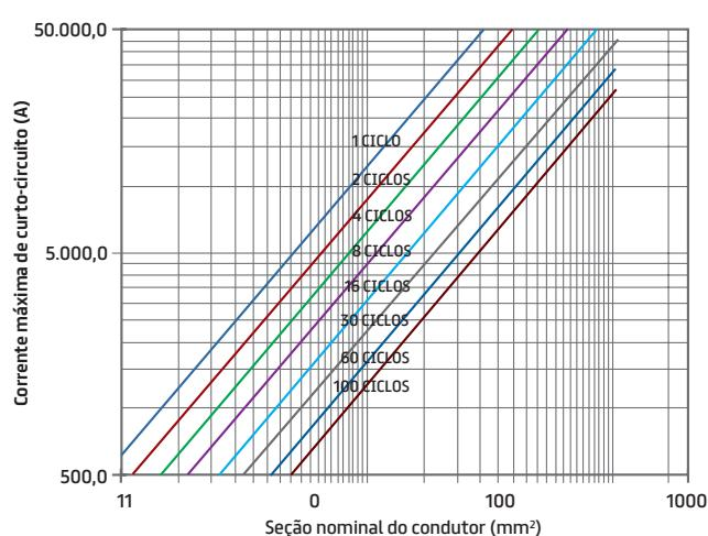
Temperatura em regime permanente de 120°C, conexões soldadas
